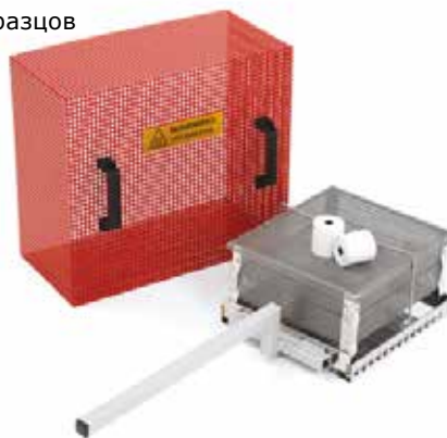
Комплект корзин для образцов (с присоединенной загрузочной ручкой), запасные рулоны бумаги для принтера и охлаждающий кожух для корзин (красный)
