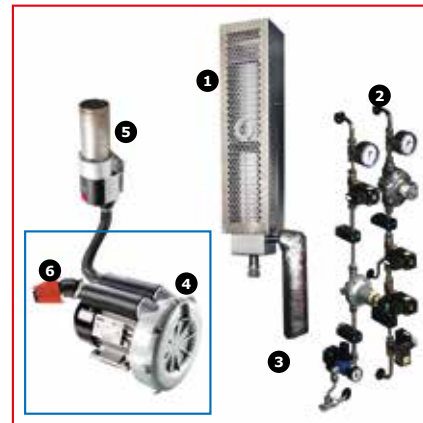
Оборудование для быстрого охлаждения (голубая рамка) и для удаления связующих (красная рамка) для печи НТФ 17/64. (датчик расхода газа не показан)
